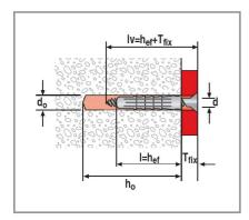
Iv= I+Tfix La lunghezza della vite si ottiene sommando la lunghezza del tassello allo spessore dell'oggetto da fissare.
