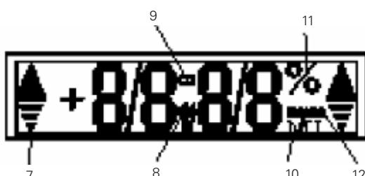
**7)** Indication de la direction par flèches (rapprochement position 0°/90°)
