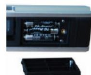
Nach dem Einlegen/Wechseln der Batterien schaltet sich das Gerät automatisch ein.
