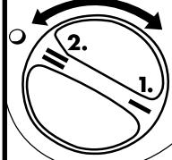
Biegi przełączać tylko przy wyłączonej maszynie.
