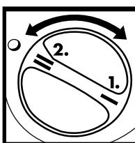
Při přepnutí z jednoho převodového stupně na druhý otočte volicí páku o 180°.
