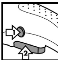
Makineyi daima iki elinizle tutun. Çalıştırma blokajı düğmesine basın (1).
