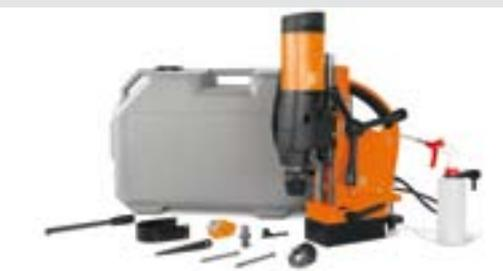
**Sono compresi nel prezzo:** 1 valigetta; 1 pompa per lubrorefrigerante; 1 cinghia di fissaggio; 1 gancio per trucioli; 1 mandrino a cremagliera di Ø fino a 13 mm; 1 adattatore QuickIN per M 18 × 6 P 1,5; 2 perni di centraggio; 1 cuneo di estrazione; 1 griglia di protezione
