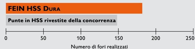
Condizioni del test: se in media i risultati ottenuti con i prodotti della concorrenza (con punte in HSS) si attestavano sui 140 fori per fresa a corona, le FEIN HSS DURA hanno consentito di realizzare 180 fori. Materiale: acciaio C 45, spessore 30 mm; Ø: 18 mm
