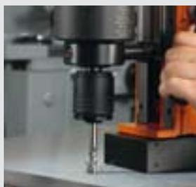
Filettatura con dispositivo di maschiatura
