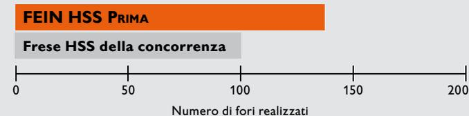
Condizioni del test: se in media i risultati ottenuti con i prodotti della concorrenza (con frese in HSS) si attestavano sui 100 fori per fresa a corona, il FEIN HSS PRIMA ha consentito di realizzare 140 fori. Materiale: acciaio C 45, spessore 30 mm; Ø foro: 18 mm
