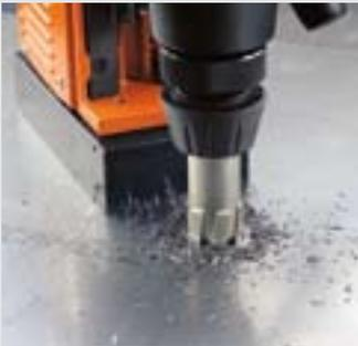
Grazie a una velocità di taglio che può arrivare ai 45 mt/min., le unità di foratura FEIN per frese a corona\* assicurano una rapida velocità di esecuzione e un'elevata redditività – praticamente su qualsiasi tipo di materiale.
