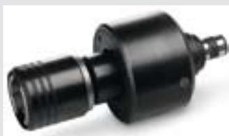
Abbinata a un dispositivo di maschiatura, anche le unità di foratura più semplici, dotate solo di rotazione destra, possono usufruire della possibilità di filettare: il dispositivo consente di effettuare la rotazione verso sinistra e estrarre con precisione il maschio per filettare fuori dal foro filettato.
