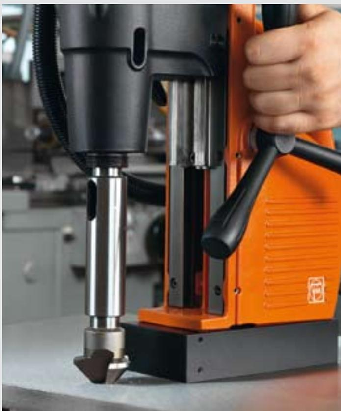
Perché dadi, teste delle viti e rivetti risultino a filo della superficie del pezzo lavorato – procedere alla perfetta sbavatura e svasatura con le unità di foratura FEIN per frese a corona.
