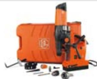
**Sono compresi nel prezzo:** 1 valigetta; 1 serbatoio del lubro-refrigerante; 1 cinghia di fissaggio; 1 gancio per trucioli, 1 mandrino a cremagliera di Ø fino a 13 mm; 1 adattatore QuickIN per M 18 × 6 P 1,5; 2 perni di centraggio; 1 cuneo di estrazione; 1 griglia di protezione
