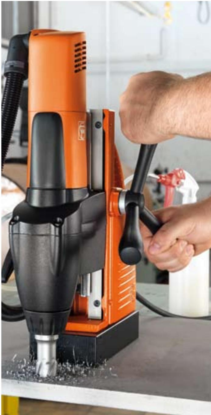
La lubrorefrigerazione interna delle unità di foratura FEIN per frese a corona consente di lavorare in modo rapido e conveniente e assicura un'elevata durata degli utensili.
