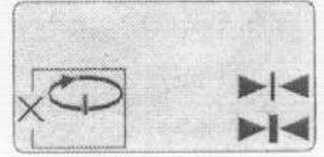
Laser orizzontale, Modalità Rotazione Ricevitore Disattivato
