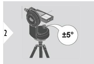
Per il livellamento, l'inclinazione del dispositivo deve rientrare nell'intervallo di  $\pm 5^\circ$ .
