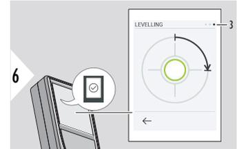
6 Ruotare il dispositivo di 90° in senso orario. Seguire le istruzioni visualizzate.
