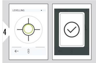
4 Regolare il Leica DST 360-X. La "bolla" verde indica che il livellamento è corretto.
