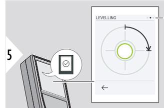
5 Ruotare il dispositivo di 90° in senso orario. Seguire le istruzioni visualizzate.
