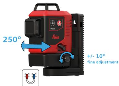
Ruotare lo strumento di  $250^\circ$  per regolare la linea verticale. Utilizzando la monopola laterale ruotare lo strumento attorno al punto di intersezione verticale/di messa a piombo entro  $\pm 10^\circ$ .
