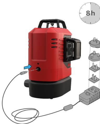
La prima volta che si usa la batteria Li-Ion la si deve caricare a una temperatura compresa tra +5°C e +45°C (+41°F e +113°F). Durante il caricamento lo strumento può riscaldarsi; si tratta di una reazione normale che non incide sulla sua durata o le sue prestazioni. Alla temperatura di immagazzinaggio consigliata, compresa tra -20°C e +30°C (-4°F e +86°F), le batterie con una carica dal 50% al 100% possono essere conservate fino a un anno. Al termine di questo periodo devono essere ricaricate.
