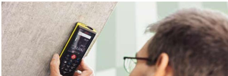
**Semplicemente appoggiando l'apparecchio sull'elemento da rilevare è possibile misurare qualsiasi inclinazione con la massima facilità.**
