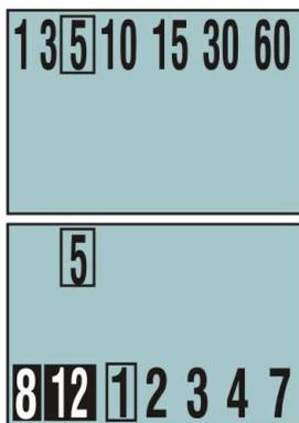
→ **PREMENDO IL TASTO ENTER CONFERMIAMO LA SCELTA: LA DURATA IRRIGAZIONE (5 MINUTI) RIMANE FISSA E SUL DISPLAY COMPARE LA RIGA DELLE FREQUENZE IRRIGAZIONE CON LA FREQUENZA 1(OGNI GIORNO) LAMPEGGIANTE**
