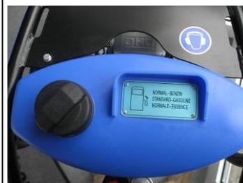
Serbatoio anti-perdita (stesso brevetto adottato da case automobilistiche).
