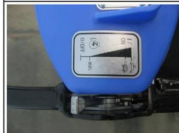
**4 posizioni definite** per la leva di regolazione del gas
